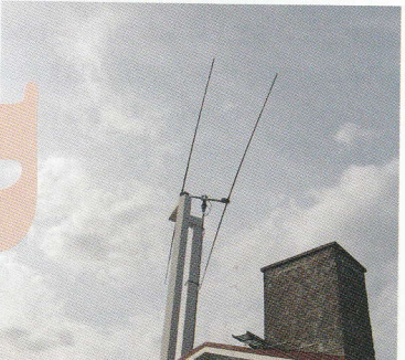
主に20~17mバンドの運用を行ったStepplr社の2エレハ木アンテナ. ほかには, 75mと40mバンドのバターネット・パーチカル. リグはFT-1000MP, リニアアンプはALPHA91β
